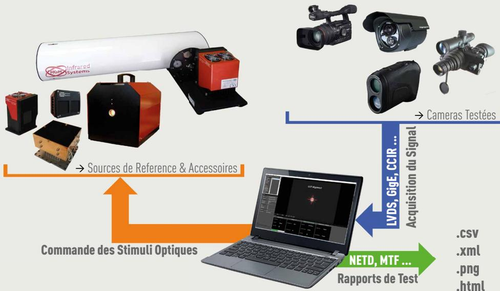
INFRATEST permet d'effectuer de multiples tests optiques d'un simple clic, en contrôlant les sources externes de référence et l'acquisition des signaux vidéo des caméras, par interprétation des protocoles standards de communication.
